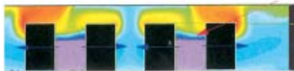
Bildung von "Wärmenestern" durch Luft-Rezirkulation.
