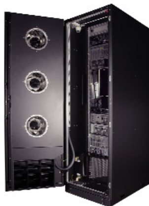
Baie de serveurs CoolTherm refroidie à l'eau (échangeur de chaleur en bas)
