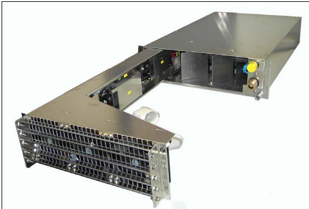
Abbildung Elektrobaugruppe komplett nach vorn herausgezogen
